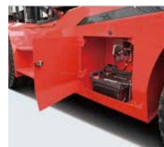
Einfach zu öffnendes Batteriefach.
