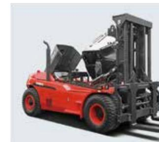
Die Kabine lässt sich bequem ohne Werkzeuge kippen. Nützlich ist dies bei der Wartung, um direkt Zugang auf innenliegende Komponenten zu erhalten.
